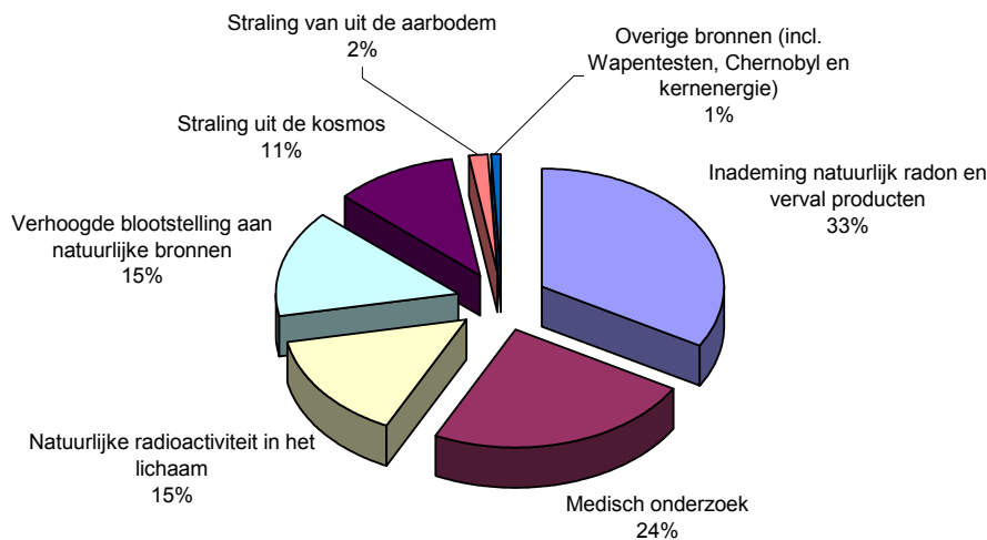
Figuur 3.2 Stralingsbelasting van Nederlandse bevolking vanuit diverse bronnen (totaal gemiddeld jaarlijks per persoon 2500 microsievvert)
