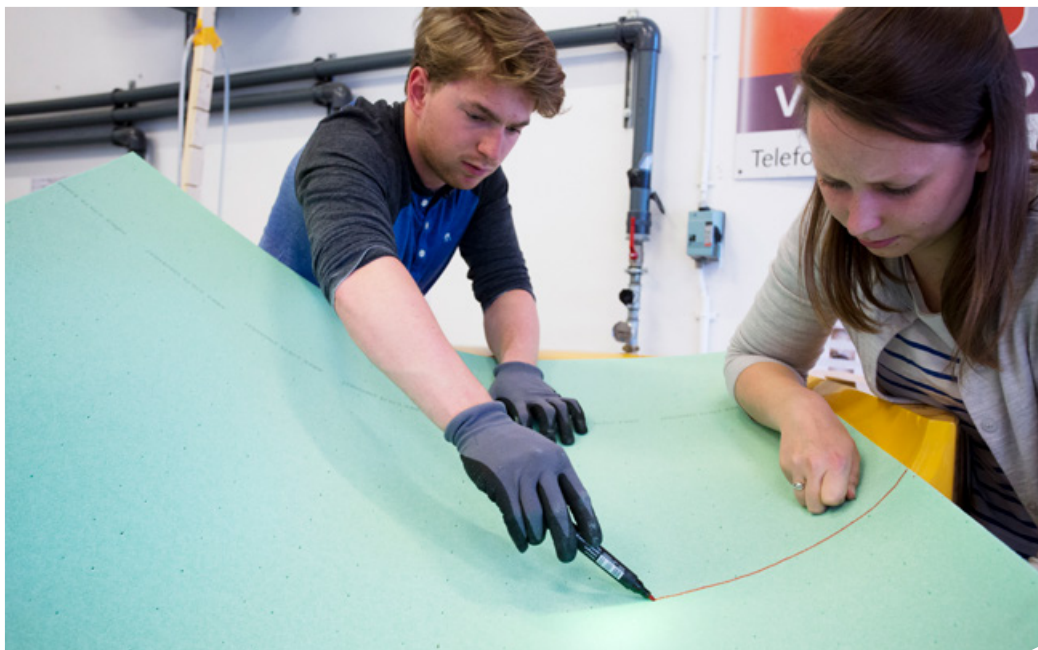
Studenten van TU Delft en VU Amsterdam leggen de schuimmatten in de mal voor de carbon kappen voor een super gestroomlijnde ligfiets. Zij willen het wereldrecord snelfietsen voor vrouwen verbreken. Foto: Bas de Meijer/HH
