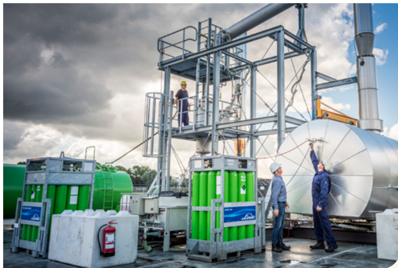
Het bedrijf CH Energy heeft een techniek ontwikkeld om uit moeilijk te recycelen afval nieuwe grondstoffen te maken. Zo kunnen autobanden worden omgezet in olie en gas. Foto: Kees van de Veen/HH
